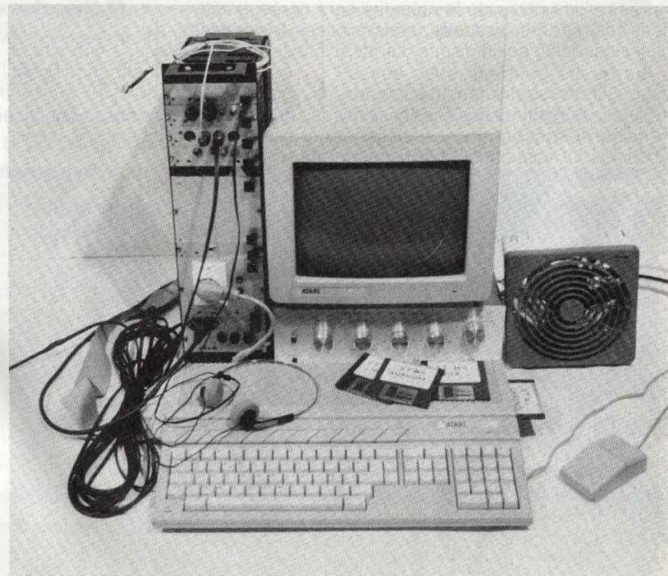
Le Rack ST Dev en "situation" avec le ST. Le ventilateur est commandé par Electra, et le rack contient toutes les cartes.
